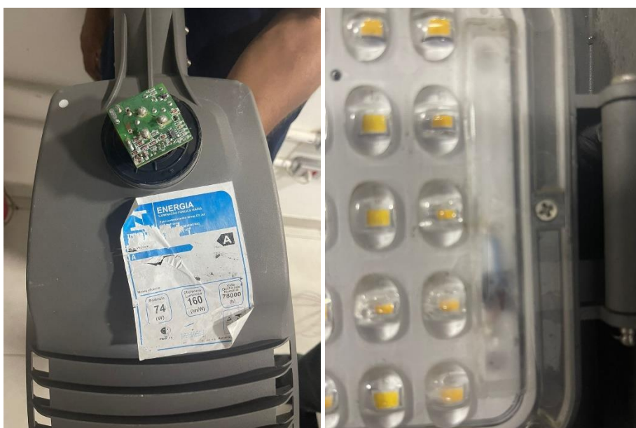
Foto 01: Luminária e placa do relé danificado.
