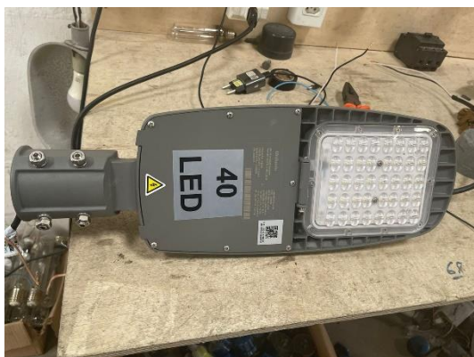
Foto 03: Luminária danificada com a sobretensão.
