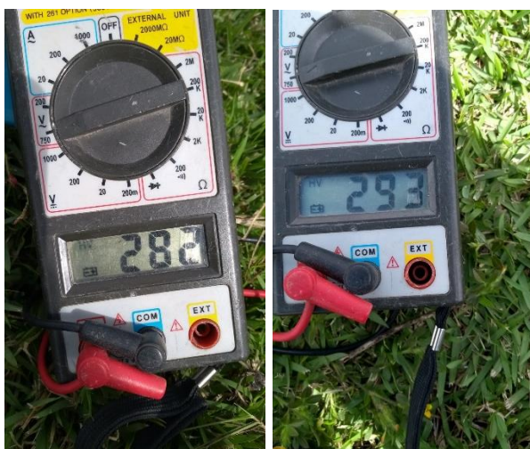
Foto 01: Medição da tensão no Parque Lagoa Grande.
